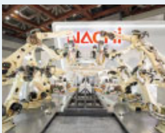
スポット溶接
