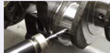
クランクシャフトへの穴あけ加工 MQL machining of a crankshaft
