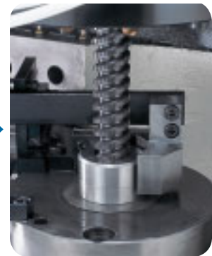
写真2 photo2 MQLブローチ加工 MQL Broaching 環境にやさしい植物油をミスト化することで、 微量給油での加工を実現
