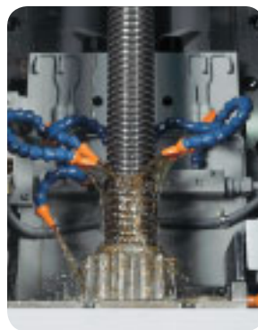
写真1 photo1 従来加工 Conventional 塩素分を多量に含有する 油性クーラントを大量に使用
